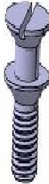
DIN 882 Montageschraube für zu tief gesenkte Bohrungen Pour les fraises trop profondes
