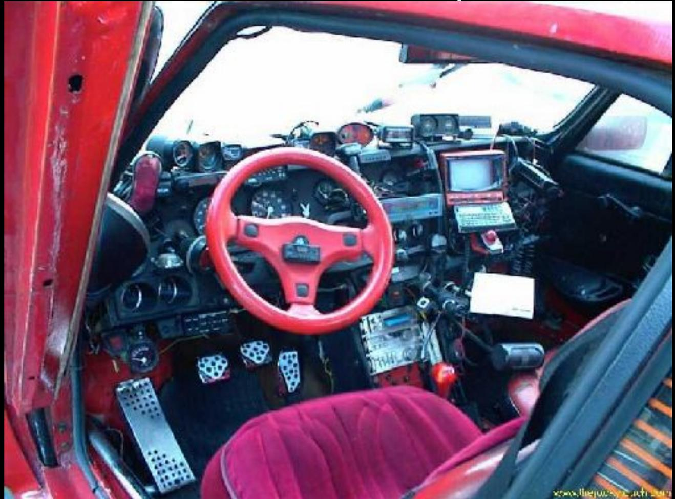
... qui en fait est constituée d'une micro-télé, d'une vieille calculatrice pour faire clavier et d'un bouchon rouge pour le trackbal !!
